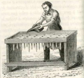
Fig. 46. — Montage des chandelles.
